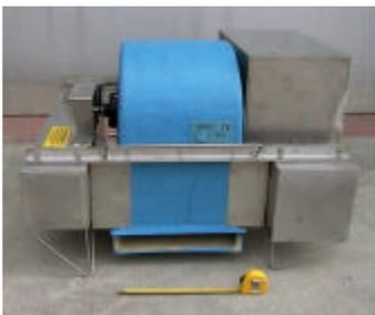
OXY FLOT è un ossigenatore flottante da utilizzare in assenza di dislivelli tra le vasche.
